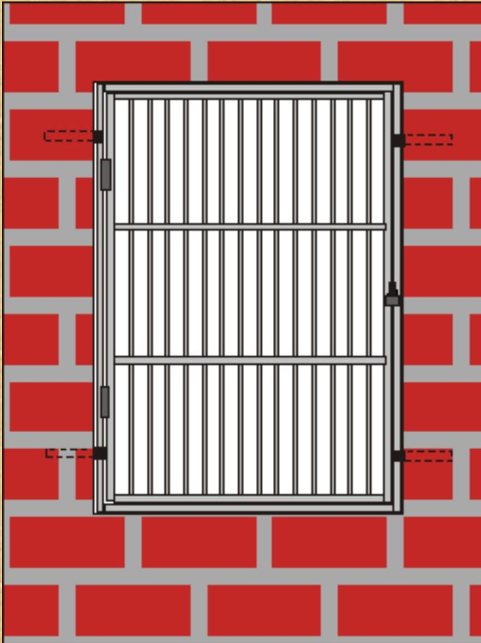
**Распашные решетки являются самым распространенным вариантом** защиты оконного проема от проникновения. Традиционно изготавливают распашные решетки с одной или двумя створками. Створки крепят к общей раме на петли, а раму приваривают к забитым в стену анкерам. В результате получается устойчивая к взлому конструкция с открывающимися створками, которые **обычно фиксируются в закрытом состоянии замком.**
