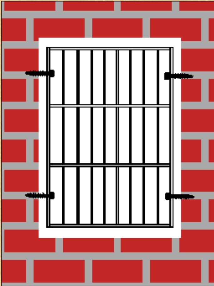
Съемные решетки крепятся к стене здания аналогично глухим на винты или анкерные болты. В этом случае снять решетку без ее повреждения возможно. Для этого необходимо выкрутить винты из мест крепления. Широкого распространения такие крепления не находят, т.к. выкручивание стандартных винтов (болтов) в плане взлома не представляется сложным, а **процесс открытия требует достаточно большого времени и инструмента, что неприемлемо, в случае экстренной эвакуации** .
