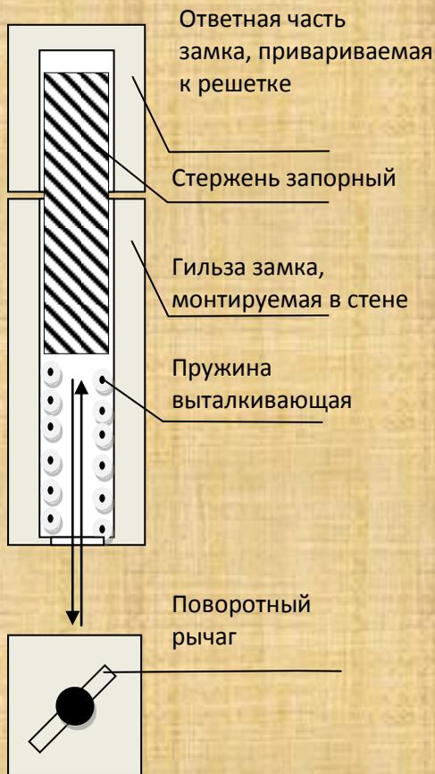
**Запорно - распашные устройства монтируются внутри стены здания, что исключает несанкционированный доступ.**
