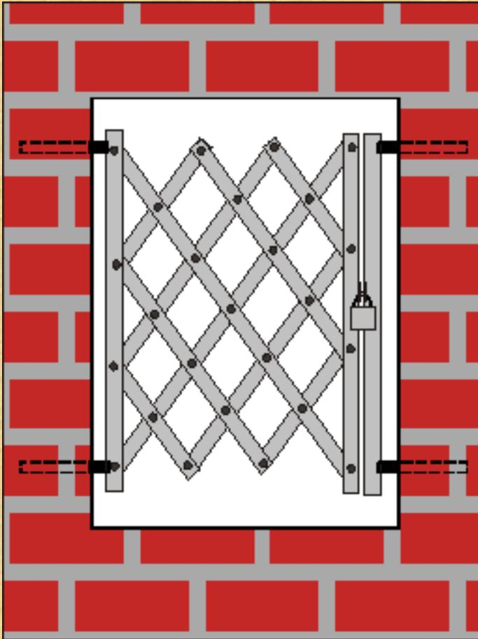
Раздвижные решетки неподвижно закрепляются в оконном проеме к стене с одной стороны, далее раздвигаются по типу пантографа. Недостаток этой конструкции заключается в относительно нежесткой конструкции, **в сложенном состоянии решетка перекрывает часть оконного проема**. Вследствие чего данный вид решеток распространен нешироко.
