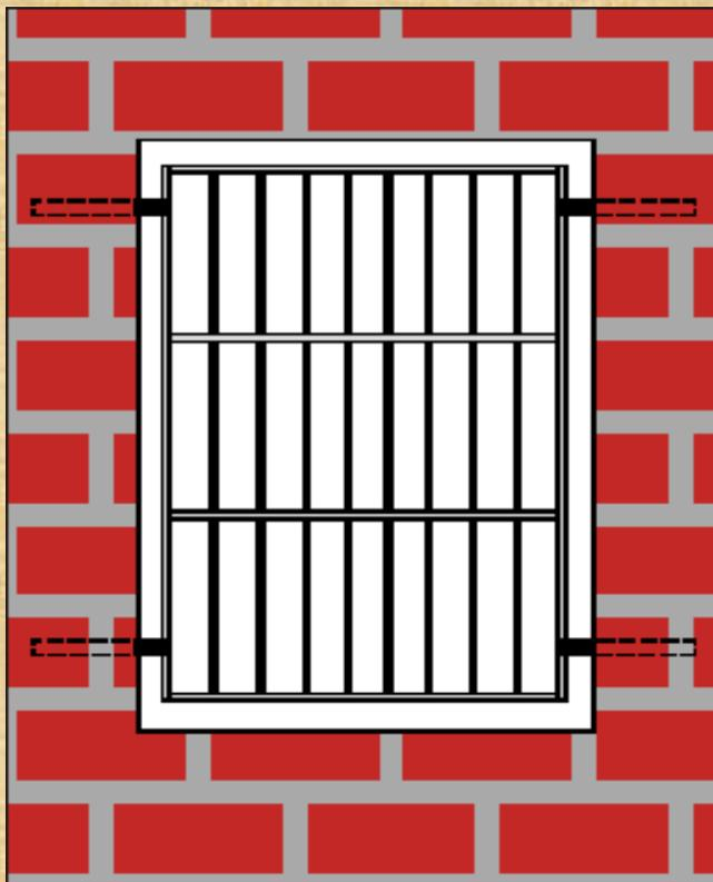
Глухие решетки привариваются к анкерам (металлическим прутам), глубоко посаженным в стену здания. Конструкция получается очень жесткой, самой надежной в плане взлома, но **без возможности открыться** в случае необходимости, поэтому **исключает возможность воспользоваться оконным проемом в качестве аварийного выхода.**
